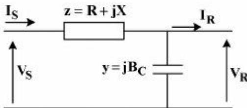
$$\begin{bmatrix} V_S \\ I_S \end{bmatrix} = \begin{bmatrix} 1+yz & z \\ y & 1 \end{bmatrix} \begin{bmatrix} V_R \\ I_R \end{bmatrix} \quad (1)$$
